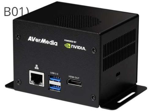
AVerMedia AVerAI Box PC NO111Bは、NVIDIA®JetsonNano™モジュール（バージョンB01）を搭載しており、物理的スペースへの懸念が高く、0° C~60° Cの温度範囲で動作する環境での業界アプリケーション向けに設計されています。91.4mm (W) x 76.6mm (L) x 70mm (H) の非常にコンパクトな寸法が特徴です。
